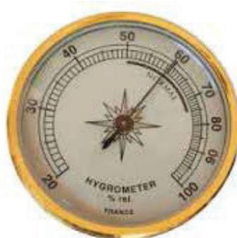
**L'hygromètre** (fig. 54) est un instrument utilisé pour mesurer l'humidité relative.
